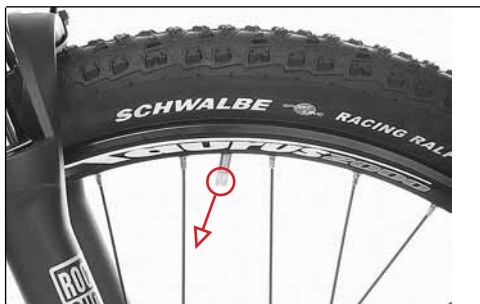
Ventil peger ikke mod hjulets midte
