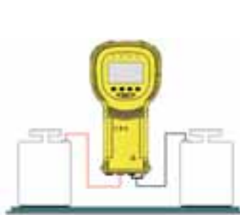
Måling: R_{p-p} Punkt-til-punkt- modstand
