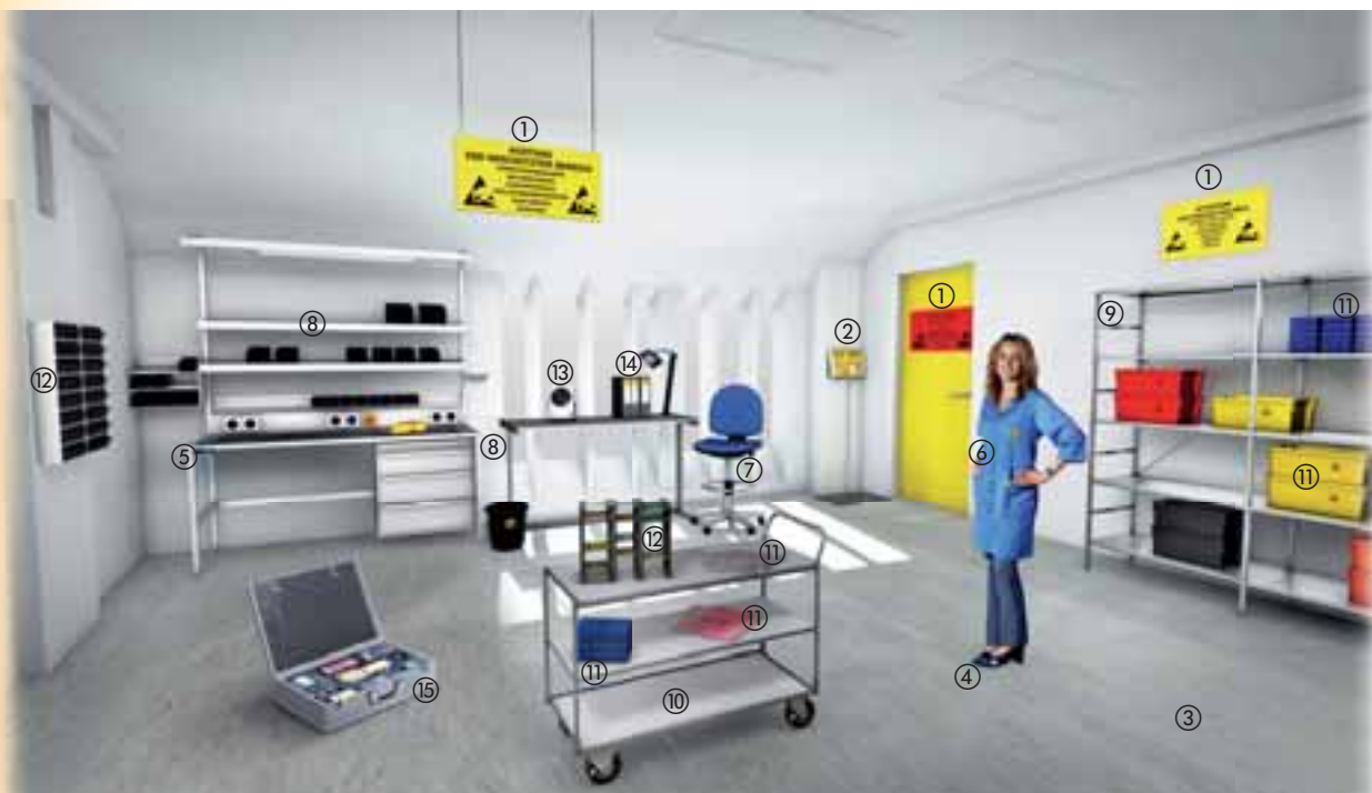
Eksempel på en ESD-sikkerhedszone (EPA)
