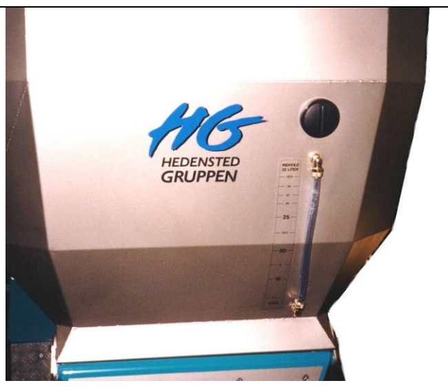
Vandstandsindikator på Feeder 500
