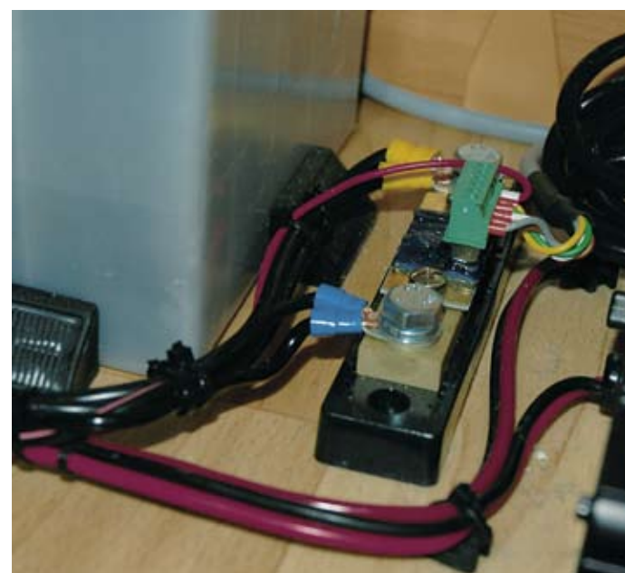
Det medfølgende shunt er placeret mellem laderen til højre og batteriet til venstre.
