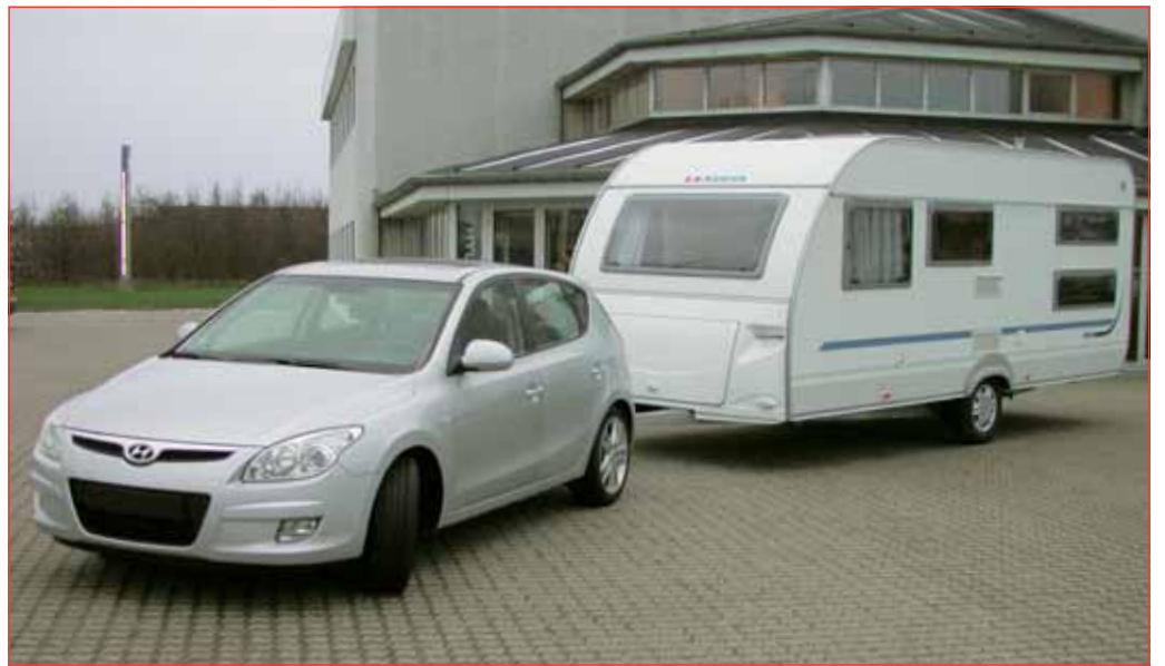
i30 – en nyudviklet familievogn, der er meget velegnet som trækker, fordi den udvikler 255 Nm allerede ved 1800 omdrejninger og bevarer trækraften op til 2750 omdrejninger. Her med en Adria Altea 512 DT familievogn
