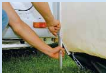
Pres gummiflapperne imod vognens side og lad den nederste del af bagstøtten støtte mod jorden og stram til.
