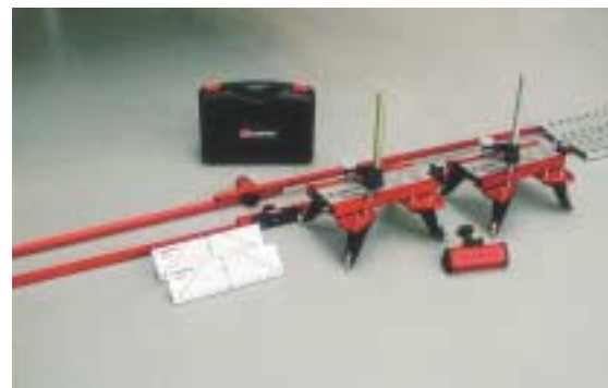
Josam udmålingsudstyr til udmåling af campingvognens aksel og undervogn, målebælkerne placeres henholdsvis på trækets kuglekobling og ophænges på magneter på vognens bagende.
