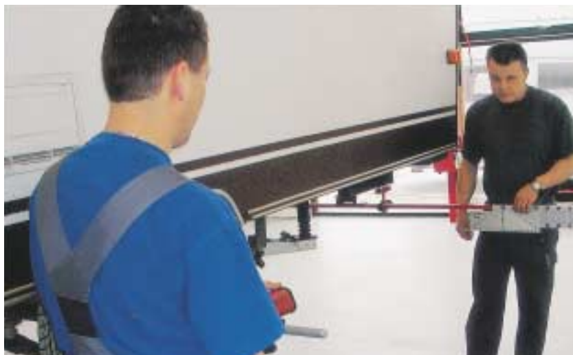
Caravanmekaniker Michal Brendholt med Josam målehoved, der via laserstrålen indikerer akslens placering på chassissrammen. Caravanmekaniker Ole Kristensen placerer mm-skalaen på gradskalaen på campingvognens bageste målebro.
