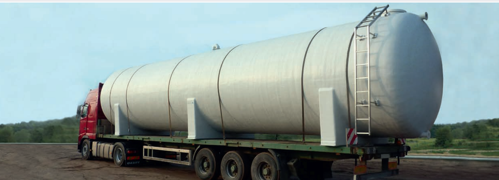
Горизонтальная, цилиндрическая наземная ёмкость из композитного материала
