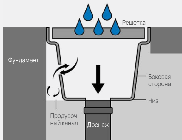
Стальной желоб, как и траншейный дренаж, подвержены химической коррозии. Композитный дренаж обладает химической стойкостью.
