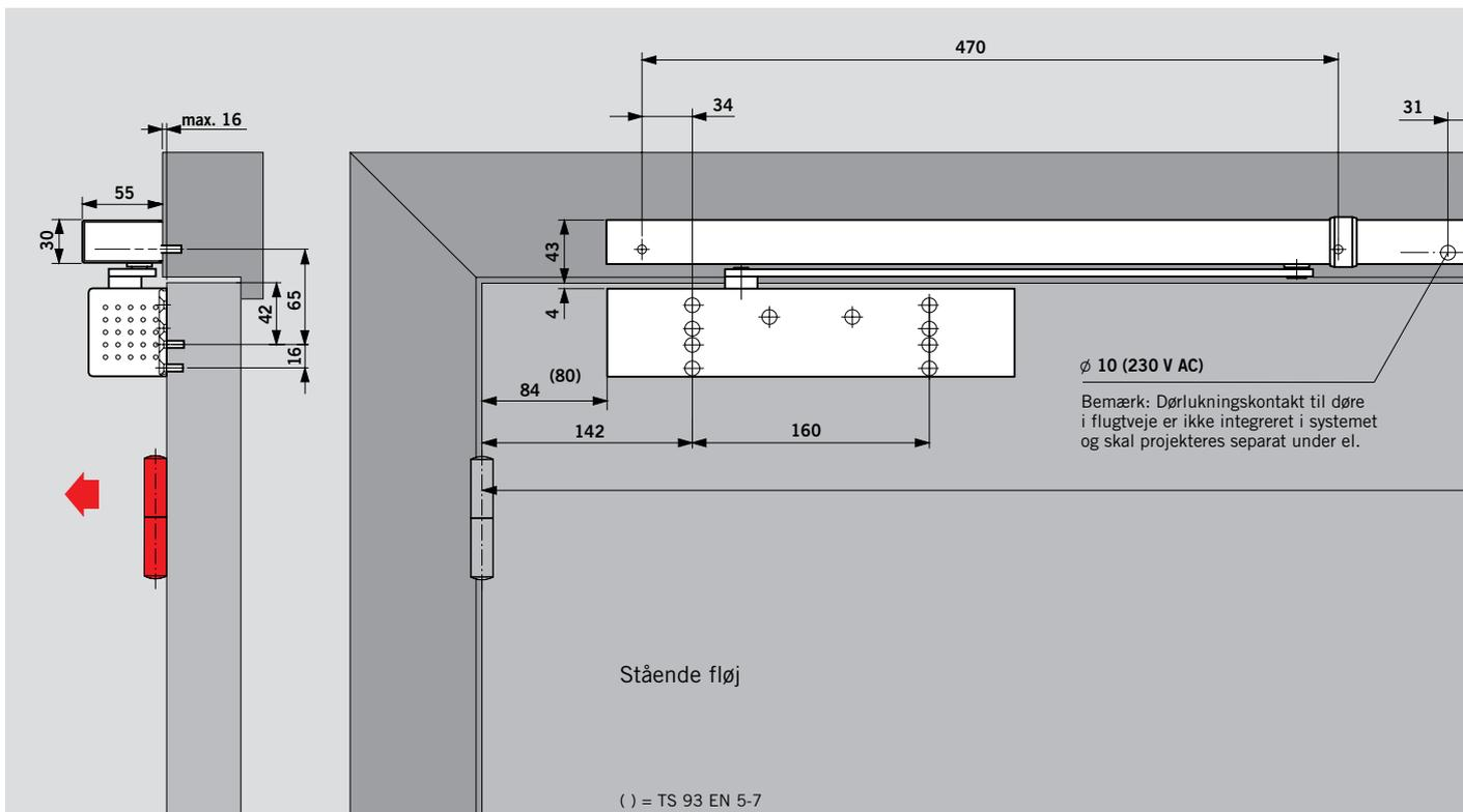
**Bemærk:** Dørlukningskontakt til døre i flugtveje er ikke integreret i systemet og skal projekteres separat under el.  $\phi$  8 (24 V DC)
