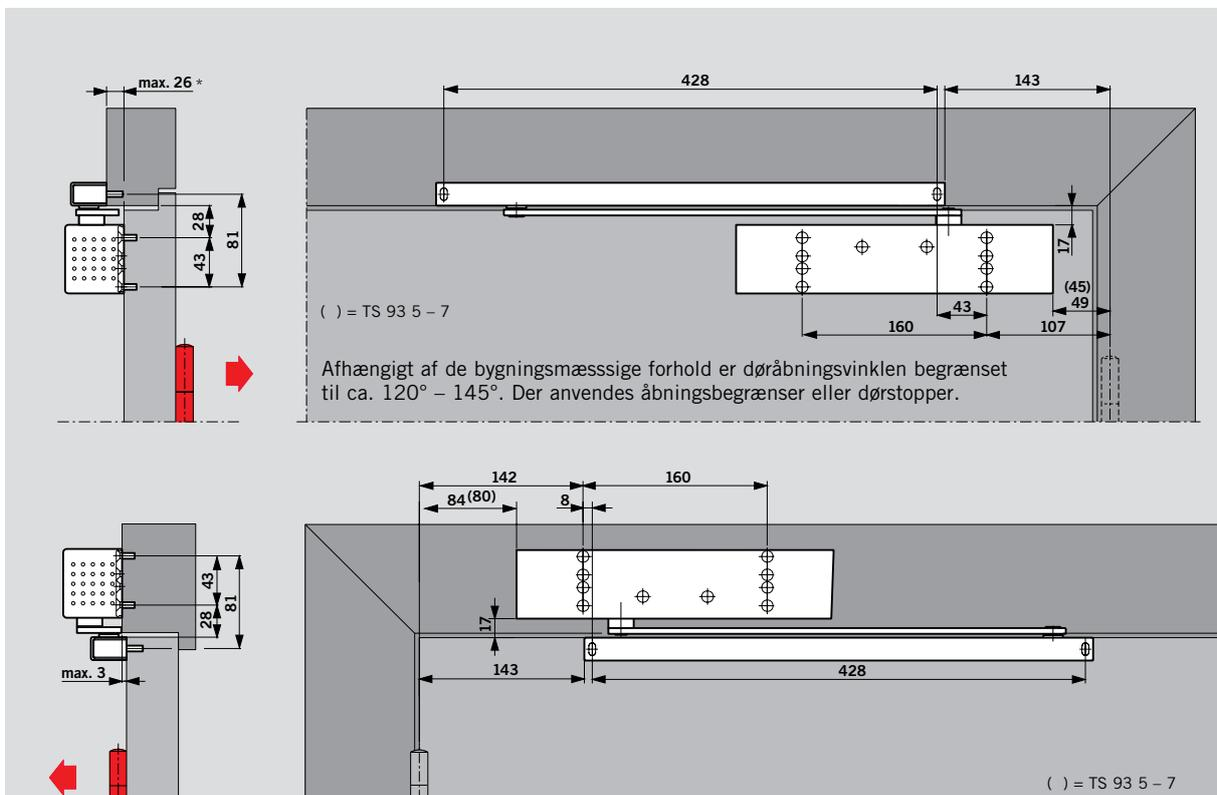
DORMA TS 93 G dørlukker på dørlad med glideskinne DORMA G-N monteret på karm modsat hængselside og lukker på karm med glideskinne på dørlad på hængselside. Eksempler: Venstredøre. Højredøre = spejlvendt.
