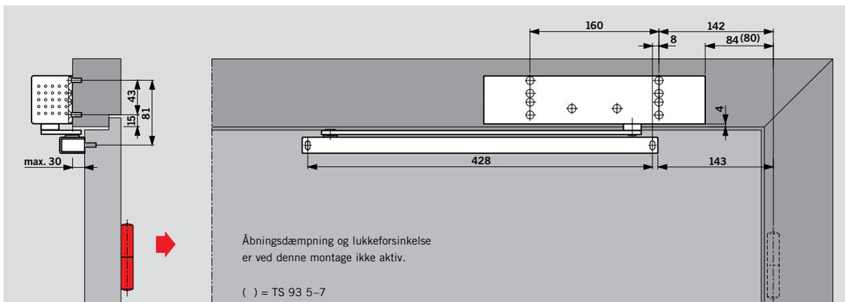
Åbningsvinkel indtil ca. 120° til 145° afhængig af dør- og hængseltype. **Vigtigt!** Ved maks. åbningsvinkel støder arm mod bagkant dør og forbliver åben. **Dørstopper** monteres inden for at undgå beskadigelser. Ved branddøre **skal** dørstopper monteres inden. Døren skal altid være
