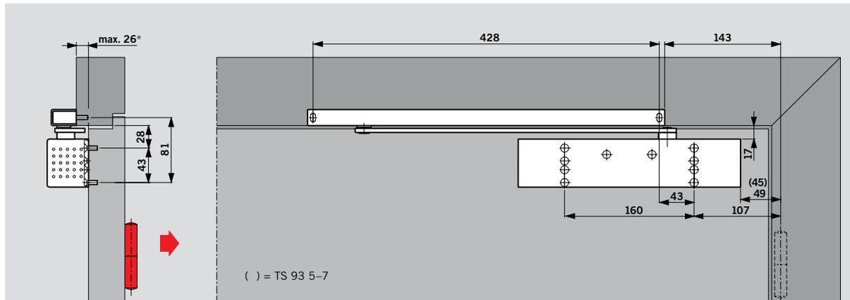
Åbningsvinkel indtil ca. 120° til 145° afhængig af dør- og hængselstype. **Vigtigt!** Ved maks. åbningsvinkel støder arm mod bagkant dør og forbliver åben. **Dørstopper** monteres inden for at undgå beskadigelser. Ved branddøre **skal** dørstopper monteres inden.
