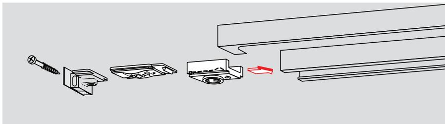
Tilbehør til DORMA glideskinne G-N: **DORMA RF** fastholdindsats indsættes (kan eftermonteres) i glideskinne og muliggør fasthold af dør i en åbningsvinkel mellem ca. 75° og maks. 150°.
