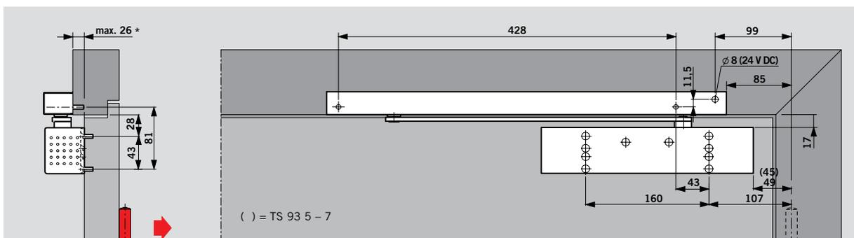
DORMA **TS 93 G** dørlukker med glideskinne DORMA G-EMF, montering modsat hængselside. Maks. åbningsvinkel ca. 140°. \*Ved dyb karm (over 26 mm) anvendes vinkelkonsol. Se side 24. Eksempel: Venstredør. Højredør = spejlvendt.
