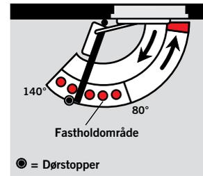
**DORMA G-EMR** glideskinne med røgdetektoranlæg og elektromekanisk fasthold monteret på dørkarm muliggør et eksakt fasthold af branddøre uden tilbageføring. Fastholdepunktet kan indstilles til en åbningsvinkel på mellem ca. 80° og 140°.
