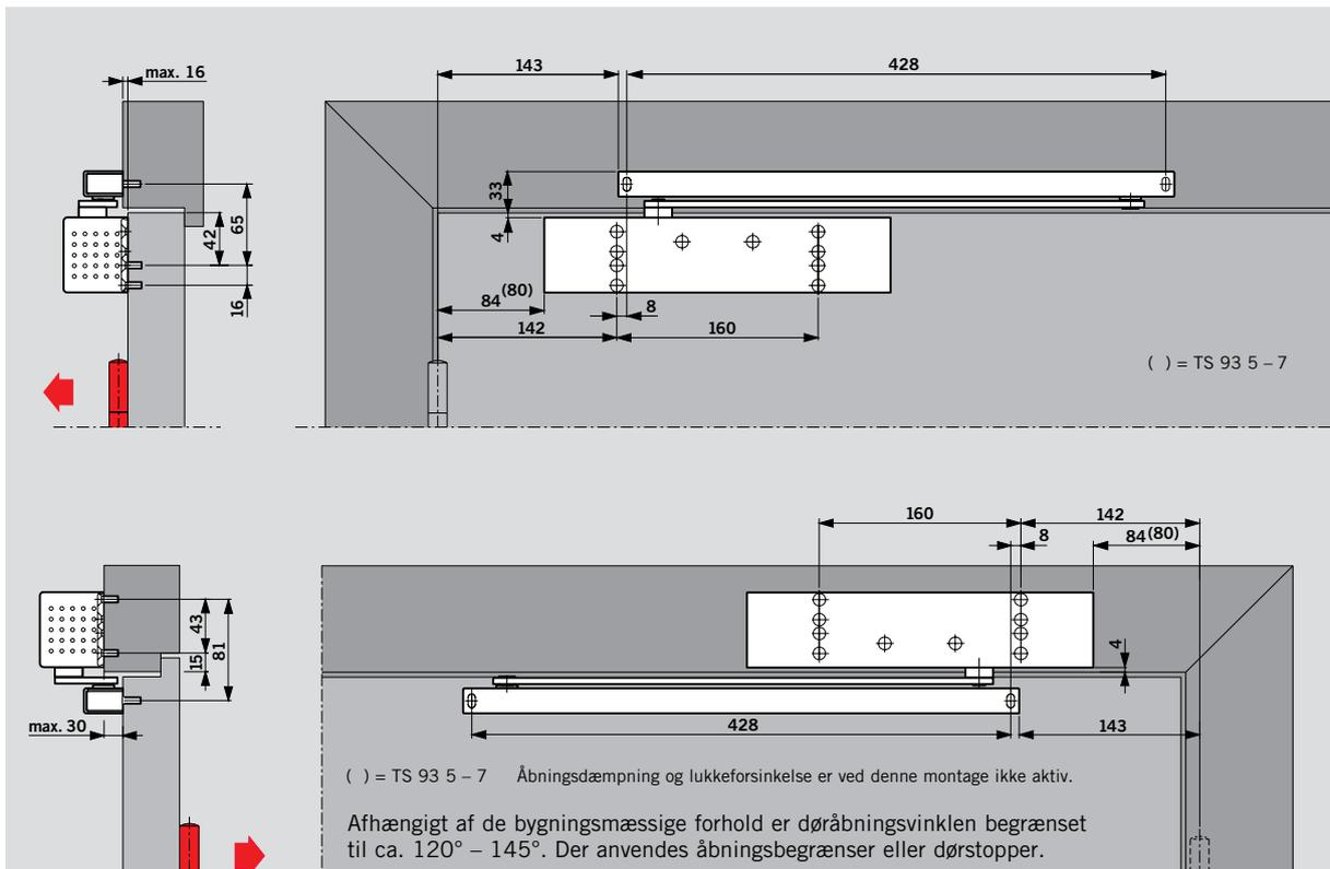
DORMA TS 93 B dørlukker med glideskinne DORMA G-N monteret på dørlad på hængselsiden og karmmontering modsat hængselside.
