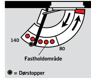
**DORMA G-EMF** glideskinne med indbygget elektromekanisk fasthold muliggør et eksakt fasthold af døren uden tilbagefjedring. Fastholdepunktet kan indstilles til en åbningsvinkel på mellem ca. 80° og 140°. Døren kan manuelt lukkes. Holdekraften indstilles på stedet til den aktuelle dør.
