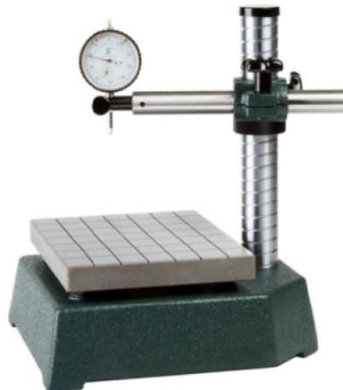
Die Messuhraufnahmen der MT 160b Typen sind auswechselbar. Lieferbar sind Aufnahmen mit 20H7, 25H7, 28H7 und 30H7 Bohrungen. Adapter für die gängigen elektronischen Längenmess-taster sind verfügbar.
