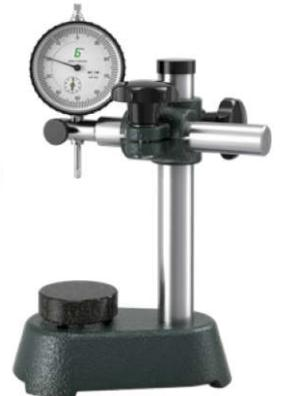
Die Tischflächen der Modelle MT 25 und MT 50 sind geläppt. Der Tisch des MT 50 K besteht aus hochwertiger Keramik  $Al_2O_3$  99,7% und ist ebenfalls geläppt.
