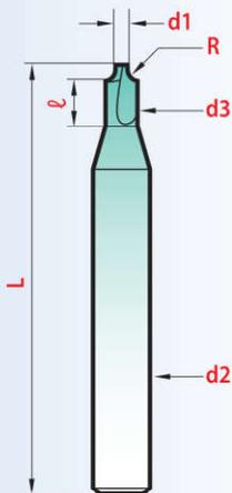
**Le rayon est positionné par rapport au petit Ø d1 :** il est ainsi possible d'usiner des formes complexes, des petites rainures et trous à partir de 0,5 mm.
