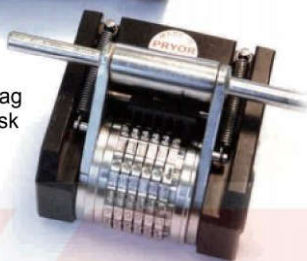
Hoved med automatisk nummerering
