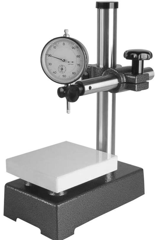
\* Die Messuhraufnahmen sind auswechselbar. Es sind zusätzliche Messuhraufnahmen mit Aufnahmebohrung 10H7, sowie Adapter für gängige elektronische Längenmesstaster lieferbar.
