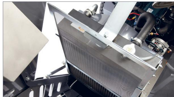
Partikelfilteret til combi-køleren sidder forrest på maskinen. Åbn motorhjelmen og træk filteret ud, når det skal blæses rent.
