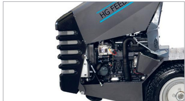
Kølegitteret foran på maskinen skal være helt frit for uld og snavs. Løft filteret op ogrens det. Fjern også eventuel snavs på vand- og oliekøler.
