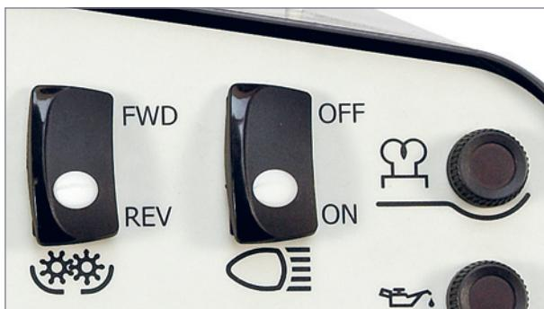
Lyskontakten er placeret th. på instrumentpanelet.
