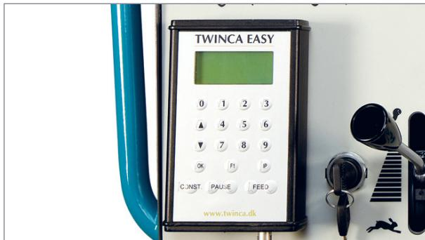
Med en fodercomputer kan du styre fodermængden, så den bliver ensartet. Se afsnit om ekstraudstyr side 17.
