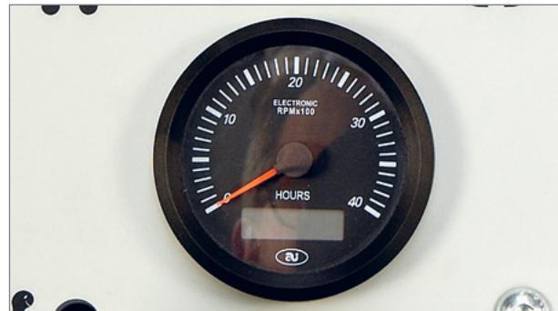
Timetælleren (nederst i midten) indikerer, hvor mange timer maskinen har kørt. Bemærk, at den tæller, så længe der er tænding på maskinen. Så husk at afbryde tændingen og fjerne nøglen, når du forlader maskinen.
