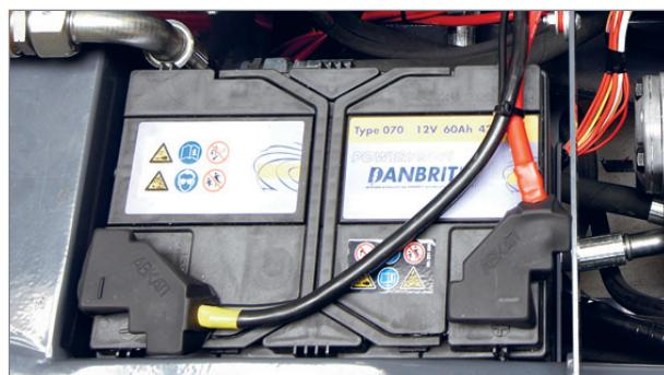
Batteriet er placeret under førersædet. Hold altid batteriet rent ovenpå. Ellers er der risiko for afladning.
