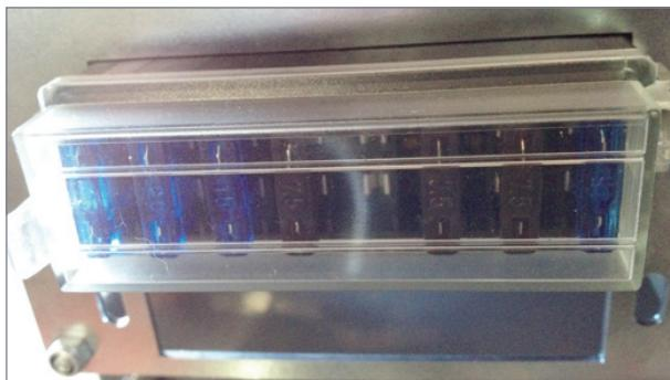
Sikringsboksen er placeret under førersædet. Sæt aldrig større sikringer i end dem, maskinen oprindeligt havde. Ved udskiftning af sikringer, se eldiagrammer side 24-25.
