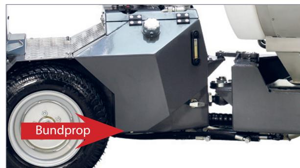
Sæt en egnet beholder under hydraulikolietanken, og fjern bundproppen. Vær opmærksom på, at der kommer store mængder olie. Sæt proppen i igen, når olien er løbet af. Fyld så ny hydraulikolie på (mængde: se specifikationer side 26).
