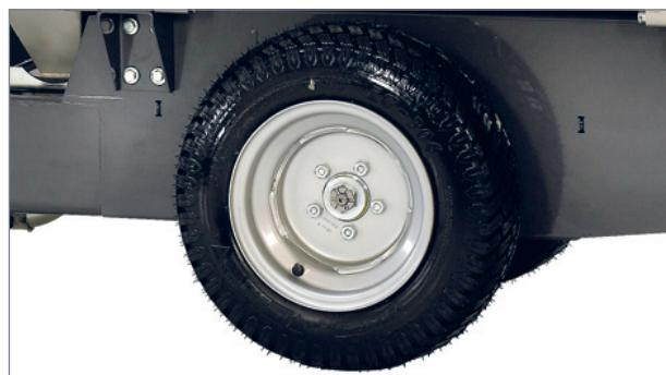
Kontrollér, at dæktrykket er korrekt. Et ukorrekt dæktryk kan gøre maskinen ustabil, og det er uforudsigeligt, hvordan det påvirker styreegenskaberne.
