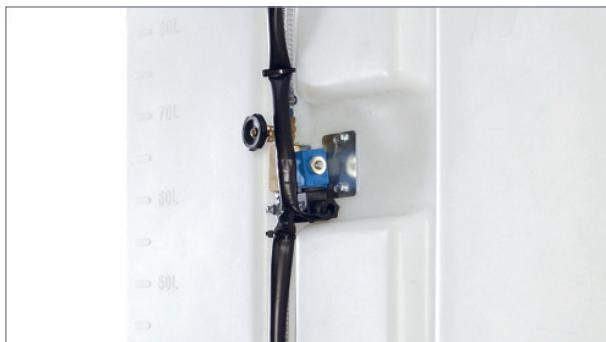
Du kan justere mængden af vand, der bliver blandet i foderet, når foderpumpen aktiveres. Doseringen sidder midt på vandtanken. Vandmængden reguleres ved at dreje på hanen. Med uret: mindre vand og mod uret: mere vand.
