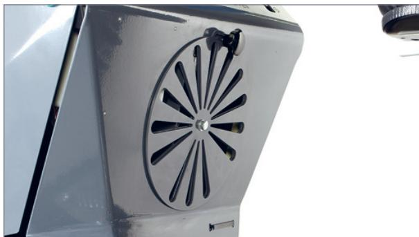
Varmeblæseren er placeret under instrumentpanelet. Den aktiveres ved at løsne stjernegrebet og dreje skiven.
