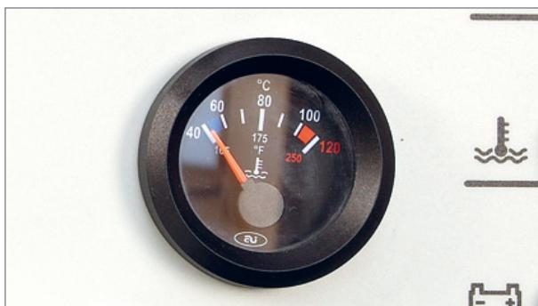
**OBS:** Hold øje med vandtemperaturen på temperaturmåleren. Hvis advarselslampen th. for måleren lyser, skal du omgående stoppe maskinen.
