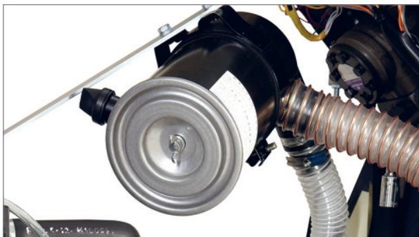
Når du skal rense eller udskifte luftfilteret, fjerner du skruen i enden af filterhuset, hvorefter filteret kan trækkes ud. Stød det let ned i gulvet, så løstsiddende snavs falder af.
