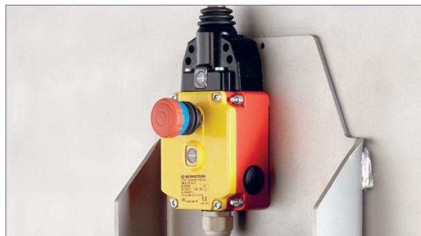
Bag på fodertanken er der monteret et nødstop. Ved reset trækker du den røde knap ud. Kontroller herefter, at den nederste indikator er grøn, og at den øverste streg er mellem pilene.
