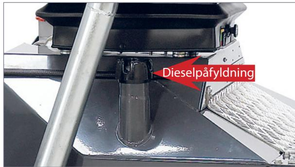
Brug almindelig dieselolie til Feeder 100/125/160 M. Mængden af brændstof aflæses ved at se ned i tanken. Normalt er dieselolie frostsikret til ca.  $-21^{\circ}\text{C}$ . Men i streng frost, dannes der paraffin i dieselolie. For at forhindre det, kan du tilsette petroleum efter følgende tabel:
