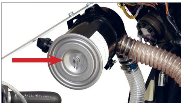
Sørg for, at luftfilteret er rent. Et snavset eller tilstoppet luftfilter sænker motoren effekt og øger både brændstofforbruget og slitagen på motoren.
