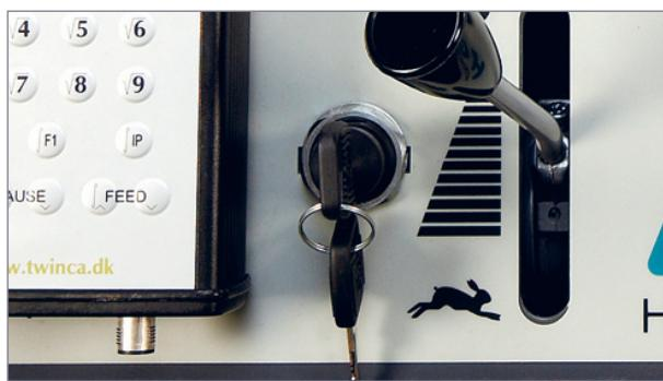
Placer gashåndtaget i øverste position. Drej herefter tændingsnøglen, så kontrollamperne lyser. Kontroller, at de alle lyser. Drej nu nøglen i næste position, og hold den der, til forvarmerlampen slukker. Drej så nøglen helt om, og motoren starter.
