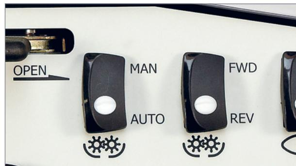
Med knappen tv. vælger du, om foderpumpen skal styres manuelt (MAN) eller automatisk (AUTO). På knappen th. vælger du, om foderpumpen skal køre frem (FWD) eller tilbage (REV).
