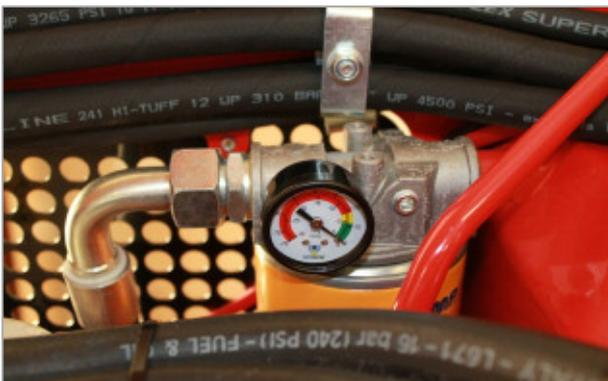
Die Kontrollleuchte am Hydraulikfilter zeigt an, ob der Filter gewartet oder ausgetauscht werden muss.
