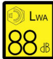
Der höchste Schalldruckpegel, gemessen am Einsatzort des Fahrers, beträgt 88 dB (A) nach ISO 6396, wenn der leere Ladekasten bei maximaler Motordrehzahl gekippt wird.
