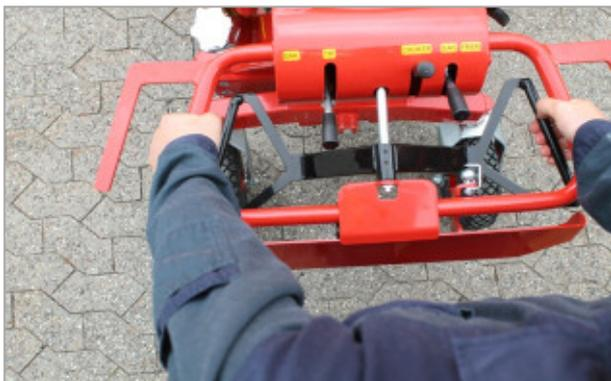
Legen Sie Ihre Hände auf den Griff so, dass Ihre Finger den Hebel in die Fahrtrichtung berühren können. Ziehen Sie den Hebel nach rechts, um die Maschine vorwärts zu fahren, und lassen Sie ihn los, um die Maschine anzuhalten. Ziehen Sie den Hebel nach links, um die Maschine rückwärts zu fahren. Überprüfen Sie vor dem Rückwärtsfahren, ob sich hinter Ihnen keine Hindernisse und keine Personen befinden.
