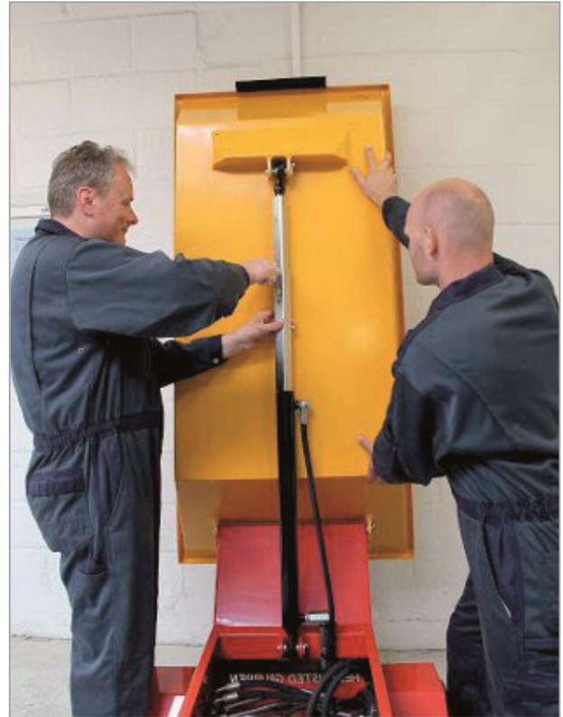
Während eine Person den Lastkasten hält, hält die andere Person die Sperrklinke am Hydraulikzylinder.
