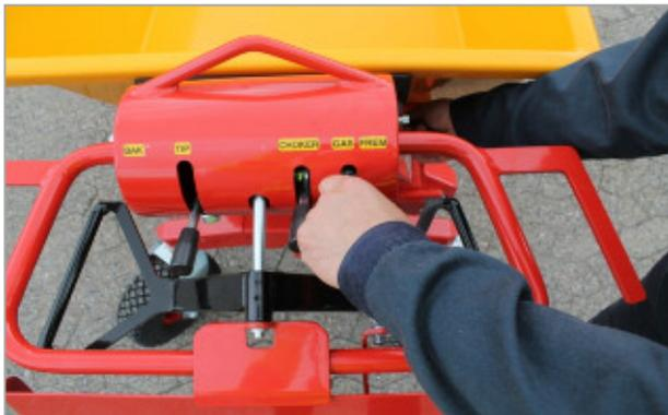
Starten Sie die Maschine, indem sie das Ansaugen bei kaltem Motor einschalten, und drehen Sie dann den Schlüssel im Uhrzeigersinn. Wenn der Motor läuft, lassen Sie den Schlüssel los und stellen Sie die Saugleistung so ein, dass der Motor leichtgängig läuft. Mit der Drosselklappe gewünschte Motordrehzahl einstellen.
