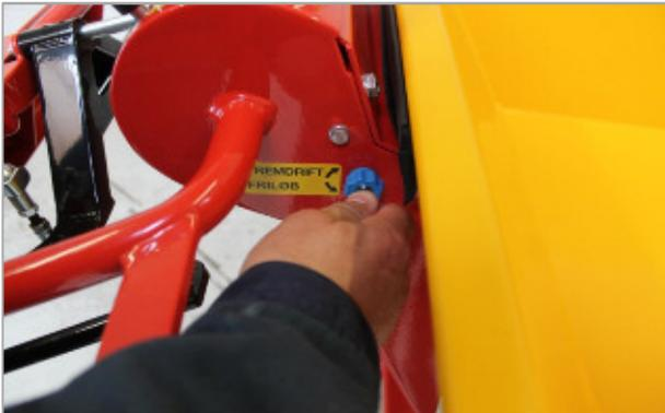
Mit dem Leerlaufknopf werden die Antriebsräder abgekoppelt, so dass sich die Schubkarre bei abgestelltem Motor bewegen kann. Drehen Sie den Knopf nach links, um ihn auszuschalten. Drücken und drehen Sie die Taste im Uhrzeigersinn, um den Antrieb wieder einzuschalten.
