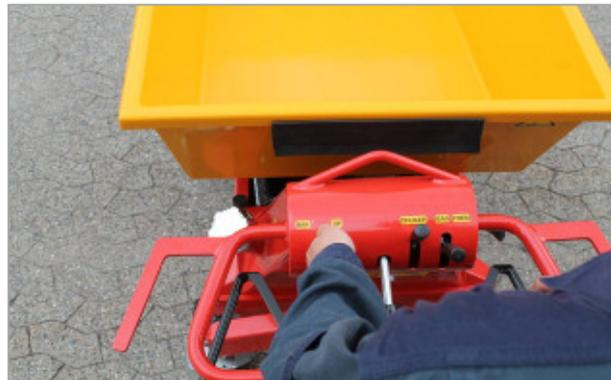
Um den Ladekasten anzuheben, schieben Sie den Kipphebel mit der linken Hand, während Sie die rechte Hand am Gurt des Griffs halten. Mit dem Hebel kann die Geschwindigkeit eingestellt werden: durch die Druckkraft wird die Geschwindigkeit eingestellt.
