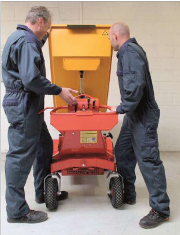
Bei einem Motorsausfall kann der Lastkasten manuell angehoben werden. Diese Aufgabe erfordert zwei Personen. Auf jeder Seite des Arbeitszylinders muss sich eine Person mit einem Fuß, der sich vor den Führungsrädern befindet. Drücken Sie den Kipphebel, während Sie den Lastkasten schieben.
