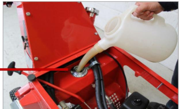
**ACHTUNG!** Den Kippschutz installieren. Gegebenenfalls Q8 Handel 46 oder ähnliches Hydrauliköl nachfüllen.
