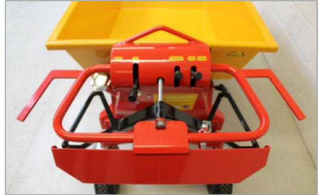
Durch Drücken der Sicherheitsplatte soll die Maschine nach vorne geschoben werden, um zu verhindern, dass der Bediener beim Rückwärtsfahren von der Maschine eingeklemmt wird.
