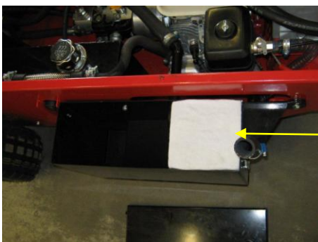
Ønskes finere filtrering brug evt. bomuldsklud uden på filteret
