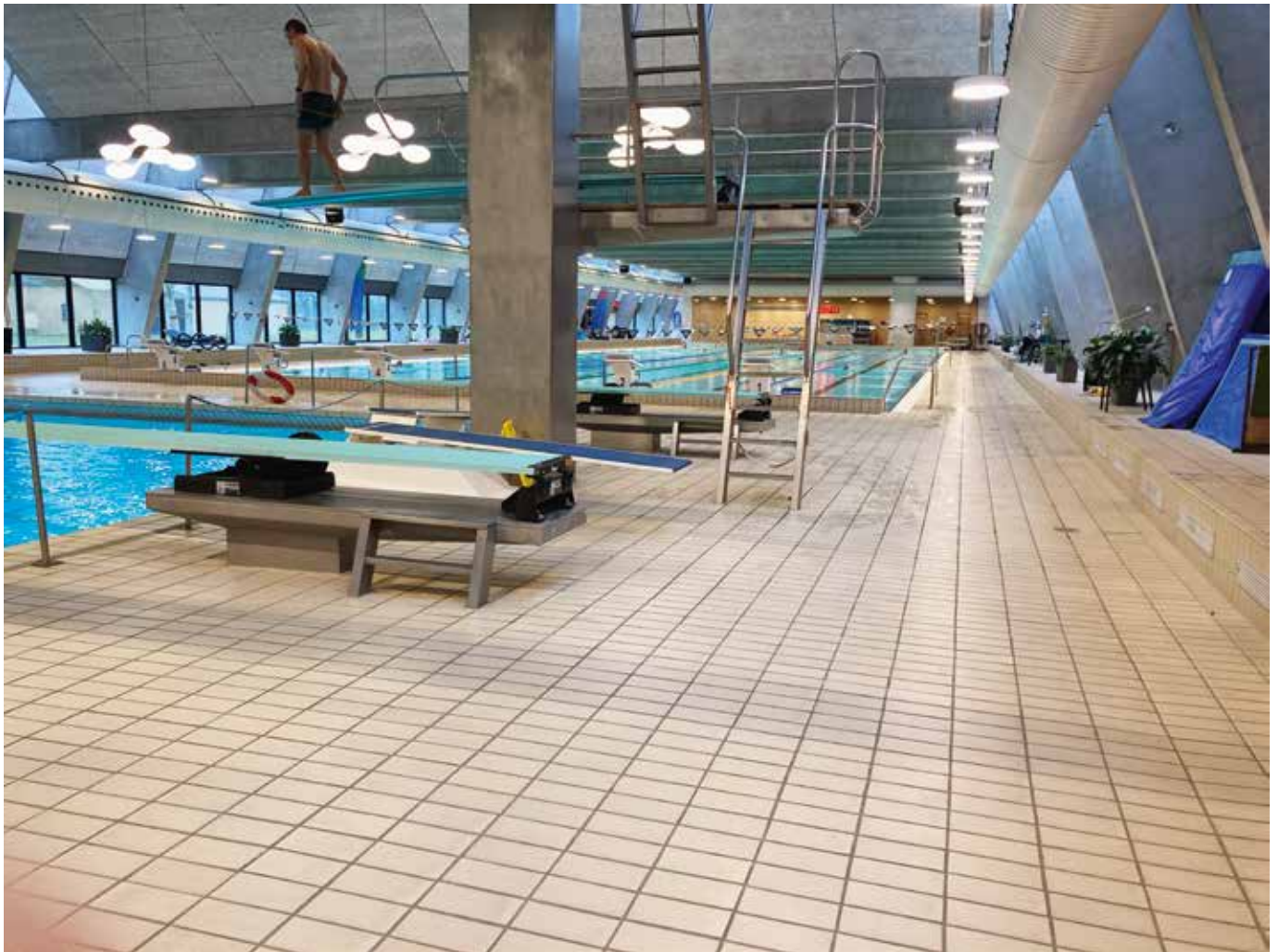
Lyngby Svømmehal fra 1977 rummer tre bassiner: Spring, svømme og baby. Bassinerne er katodisk beskyttet og er udført uden membran under fliserne.
