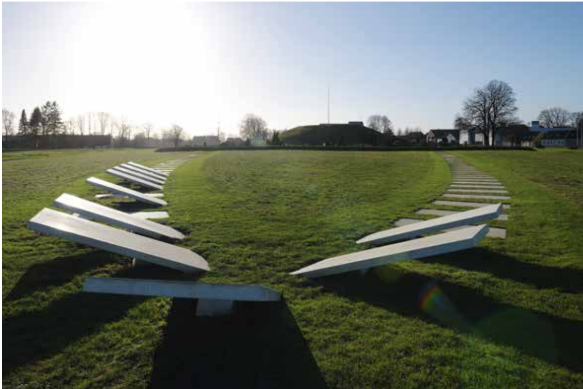
Skibssætningens geometri er markeret med hvide betonfliser i formatet 120x240 cm og en tykkelse på 10 cm – en del af dem placeret i en vinkel, så markeringen illuderer skibsform.
